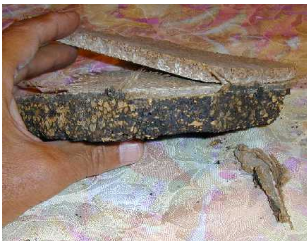
Détachements : entre finition et support en panneaux agglomérés ainsi qu'aux milieux de ces panneaux
