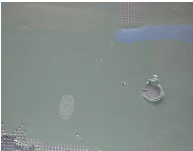
Erreurs de mélange ; le polyuréthane a seulement partiellement polymérisé et doit être enlevé
