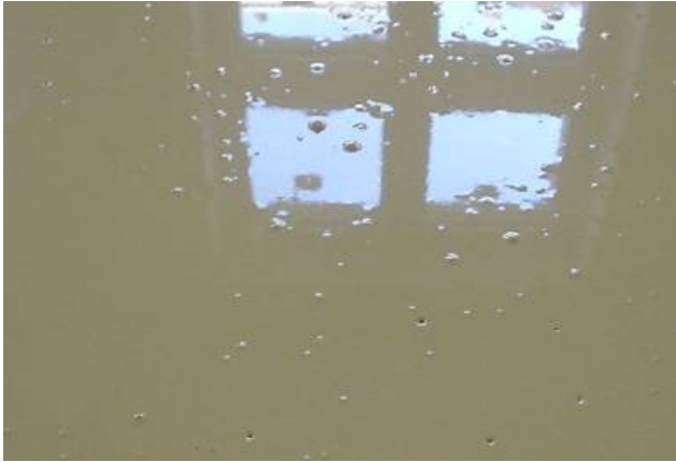
Bulles et trous dans la finition
