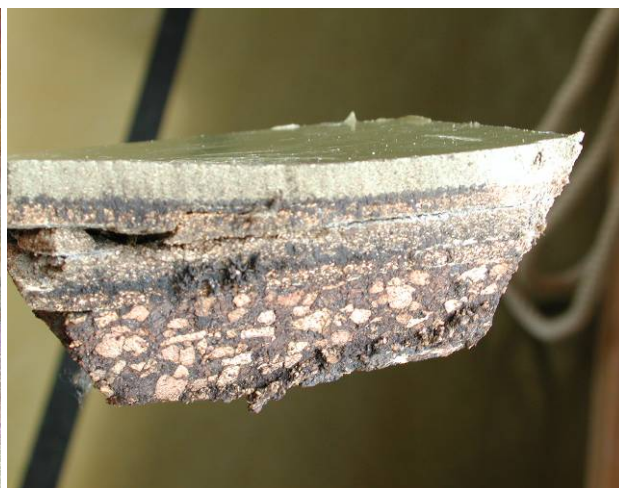
Détachements : entre finition et support en panneaux agglomérés ainsi qu'aux milieux de ces panneaux
